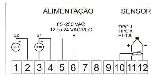
Observação: É possível utilizar sensor PT-100 dois fios, observando-se porém que essa configuração limita o cabo do sensor em no máximo 5 metros de comprimento. Para utilizar o sensor PT-100 dois fios será necessário curto-circuitar os terminais 10 e 11 e colocar o sensor nos terminais 11 e 12.
