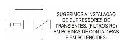
SUGERIMOS A INSTALAÇÃO DE SUPRESSORES DE TRANSIENTES, (FILTROS RC) EM BOBINAS DE CONTATADORES E EM SOLENÓIDES.
