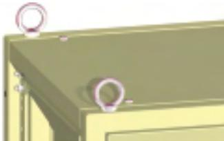
Instalação das argolas de içamento, na furação existente nas colunas
