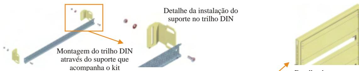
Detalhe de montagem trilho DIN
