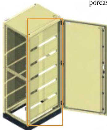
Montagem rack fixo no painel, com tampas cegas e tampas perfuradas. O rack fixo pode ser fixado em qualquer profundidade do painel, pelos perfis laterais e cantoneiras
