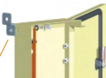
Fixe o suporte de fixação externo utilizando as furações existentes na parte posterior do quadro
