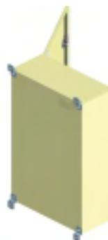
Vista posterior do quadro de comando com os suportes de fixação instalados
