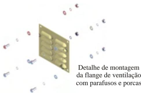
Detalhe de montagem da flange de ventilação com parafusos e porcas
