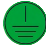
Etiqueta de identificação do ponto de aterramento, colada na placa de montagem, ao lado do parafuso de aterramento
