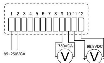
PARA MEDIÇÃO AC UTILIZAR OS CONTATOS 9 E 10
